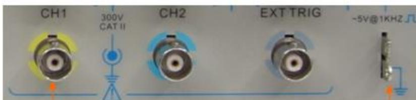
Канал 1 для подключения щупа
