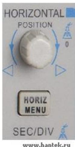
**1. Ручка ГОРИЗОНТАЛЬНОГО ПОЛОЖЕНИЯ:** Используется для настройки положения триггера относительно центра экрана.
