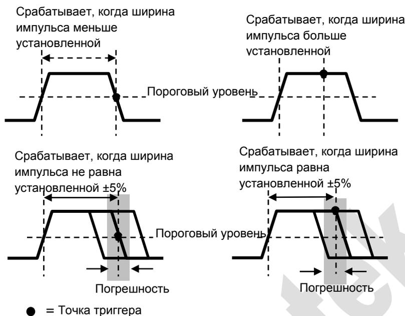
=, ≠: С погрешностью ±5% осциллограф срабатывает, когда ширина импульса сигнала равна, или не равна установленной ширине импульса.
