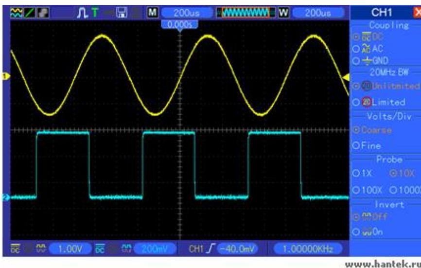
Как показано на рисунке выше, на входе мы имеем синусоидальную волну 1кГц с CH1 и прямоугольную волну 1кГц с CH2.
