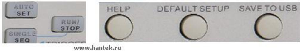
**AUTOSET:** Автоматически настраивает элементы управления осциллографом для генерирования отображения входных сигналов. Обратитесь к следующей таблице для соответствующего содержания.
