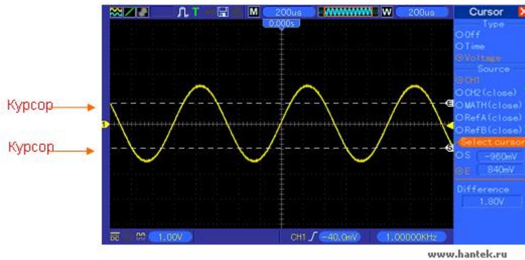
**Автоматическое измерение:** Осциллограф в этом режиме выполняет все расчеты автоматически. Так как данное измерение использует точки записи осциллограмм, оно более точное, чем измерение с помощью координатной сетки и курсоров. Автоматическое измерение отображает результаты измерения в показаниях, которые периодически обновляются при получении новых данных осциллографом.
