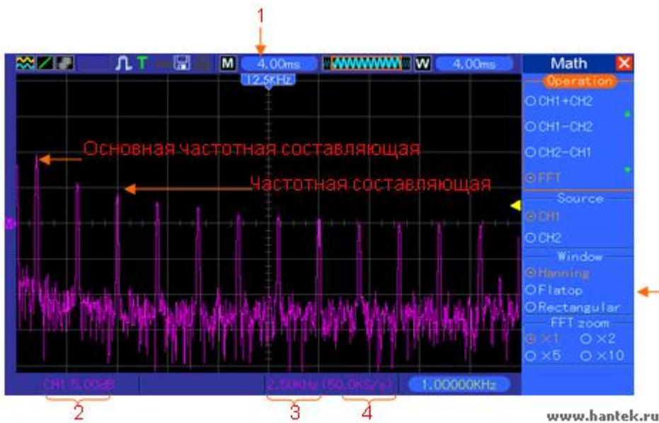
1. Частота в центральной линии координатной сетки
