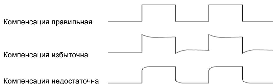
3. Если необходимо, используйте неметаллическую отвертку, чтобы настроить переменную емкость щупа до получения формы сигнала, соответствующей рисункам выше. При необходимости повторите этот шаг. См. рисунок ниже для способа настройки.
