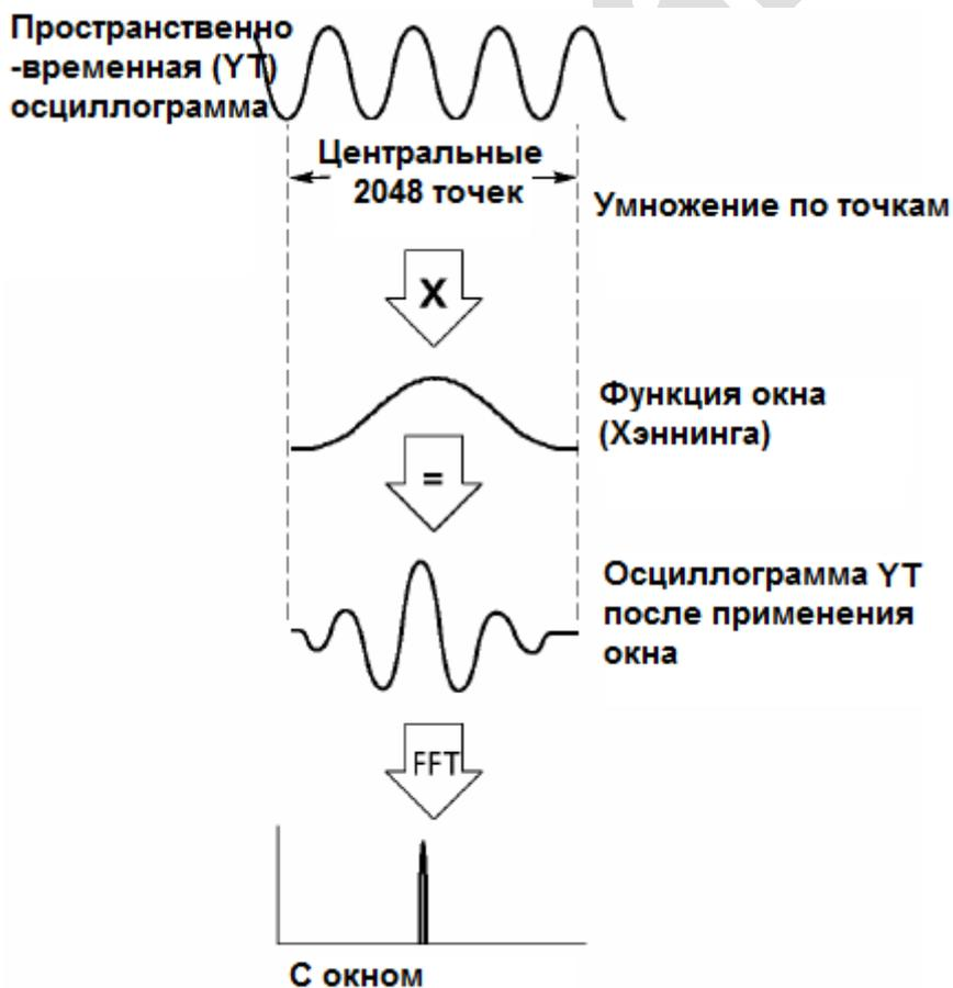
Функция математического расчета БПФ имеет три варианта окна БПФ. Существует выбор между разрешением частоты и точностью амплитуды для каждого типа окна. Вам следует определить, что выбрать, в зависимости от объекта, который вы хотите измерить, и характеристик сигнала источника.
