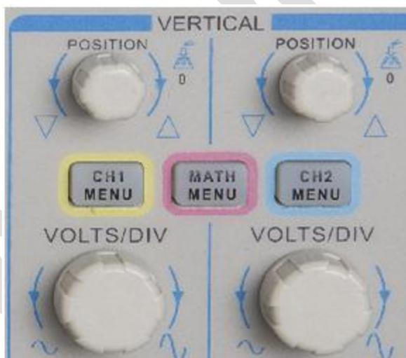
2. **Меню (CH1, CH2):** Отображает опции вертикального меню; включает или выключает отображение осциллограммы каналов.
