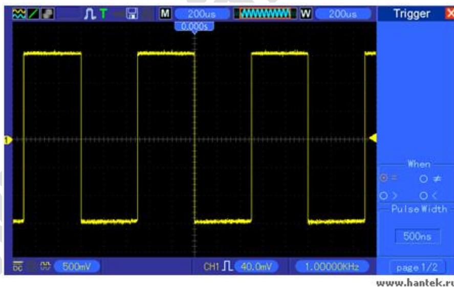
Как показано на рисунке выше, вы можете получить стабильно отображение сигнала при входе прямоугольной волны с частотой 1 кГц и шириной импульса, установленной на 500 мкс.
